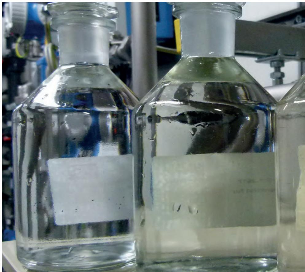
Vom Kläranlagenablauf (Probeflasche rechts vorne) zum stabilen Betriebswasser (linke Probeflasche)
