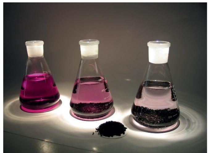
Abbildung 1: Entfärbung mit Aktivkohle (Quelle: IWW)
